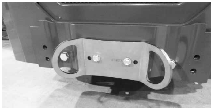
Az A418623 lekötöző tartóelem a hátsó lökhárítónál vagy az ellensúlynál van felszerelve
