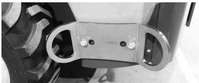
Az A418623 lekötöző tartóelem a hátsó vázrész oldalánál van felszerelve Oldalsó felszereléshez két lekötöző tartóelemre van szükség.
